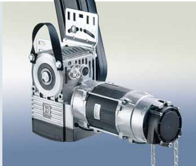
Двигател WA 400 с кутия за веригата и верига за ръчно задействане при авария (възможност за управление от пода)
